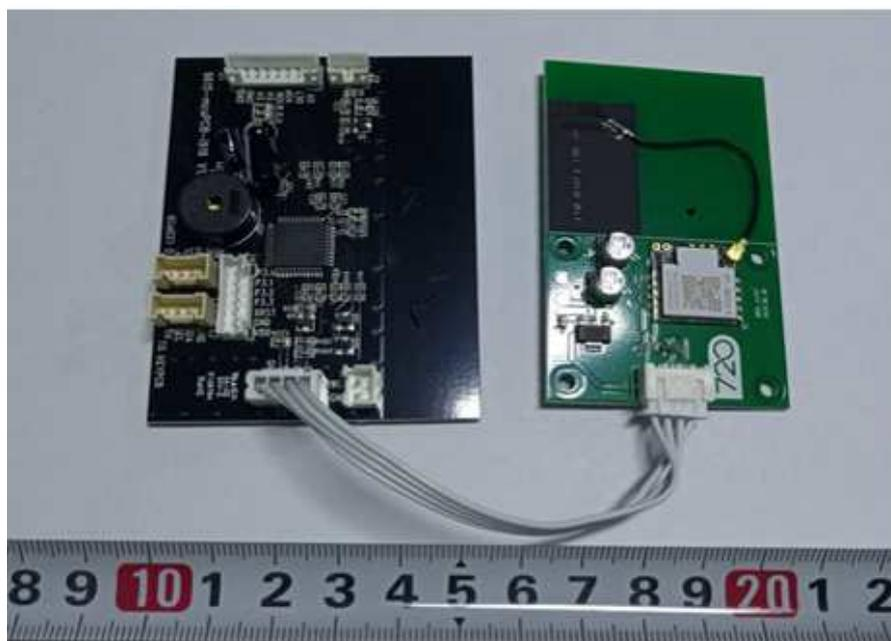
变更后控制电路板正面照片
