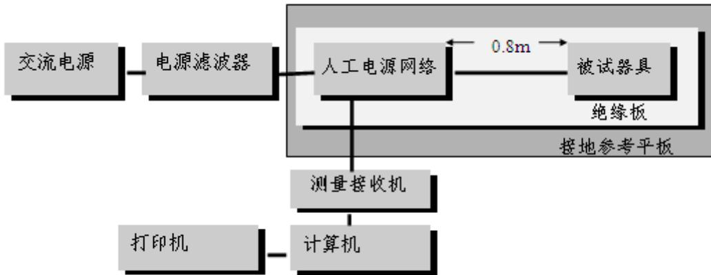
EUT 在  $\square 0.1\text{m} / \square 0.4\text{m}$  高的绝缘支撑上。
