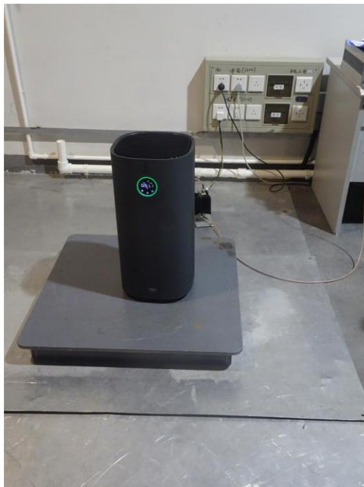
**试验结果:**环境温度: 24 °C 相对湿度: 50 %RH电源电压: 220 V 电源频率: 50 Hz被试器具工作状态: 正常工作+最大风量
