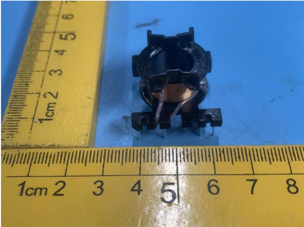
图 9 变压器初级绕组 (N1)
