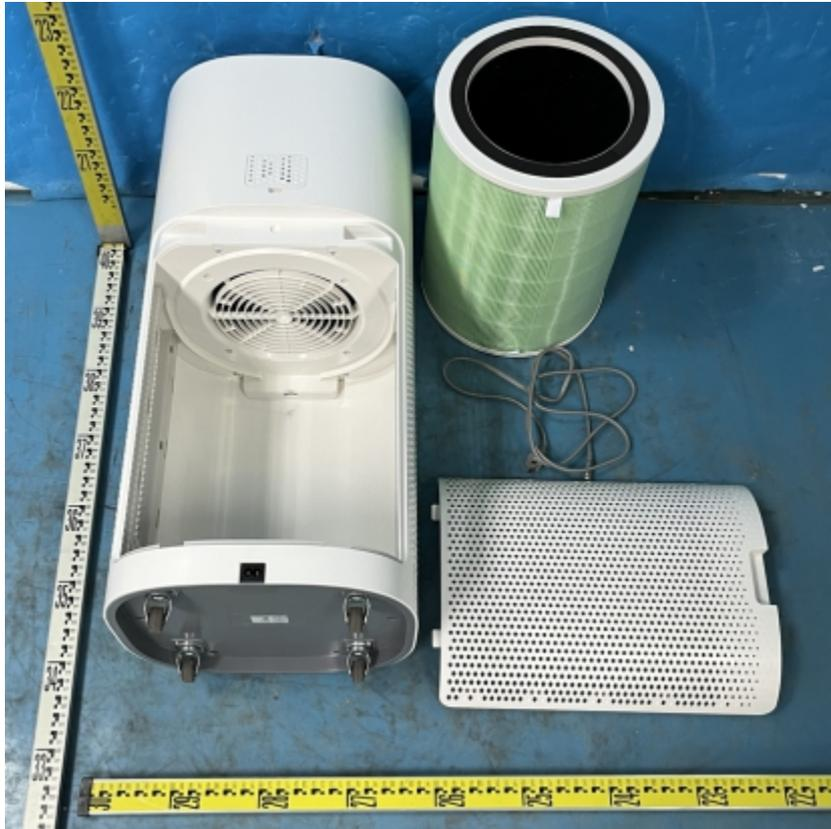
型号 KJ600F-E600 输入插口和电源线
