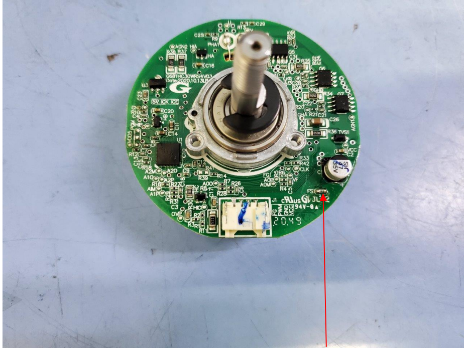
PCB for Fan Motor G0655KHV09, Fuse FS1
